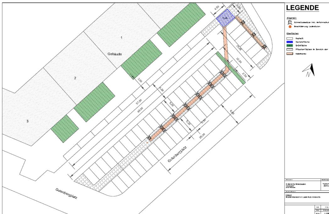
**Abbildung 39: Errichtungskonzept LIS am Gutenbergplatz (siehe Anlage 7)**
