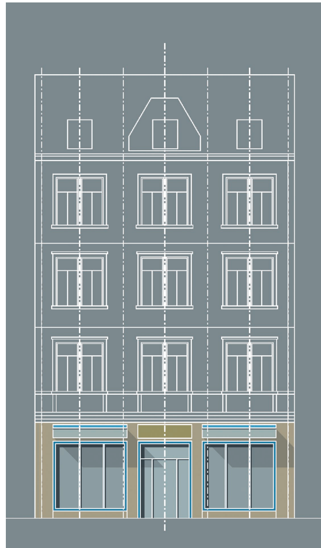
Ladenzone mit massiven Stützfeilern
